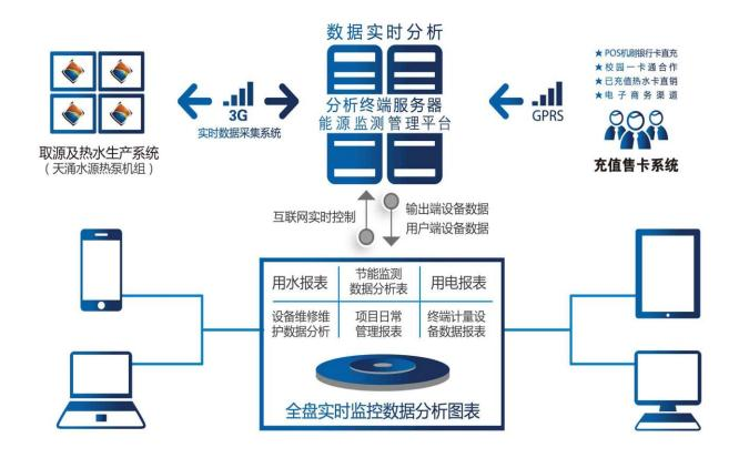
通过精确分析设备耗电量、减排量,监督项目各端口设备运行数据,实现对项目各端口硬件设施设备的实时监管,设计项目最佳运行方案并通过远程控制系统实现,同时,通过实时抓取项目用水、用电、热水卡充值使用情况,与 POS 机充值管理平台、公司 ERP 信息一体化管理平台"对写接口、共享数据"的方式,实现项目经济效益的实际测算和预警,帮助获得项目的整体运行数据,提高项目管理效率和风险控制能力。
